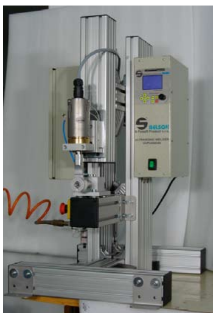
Príklad pneumatickej ultrazvukovej zväračky firmy Belson
