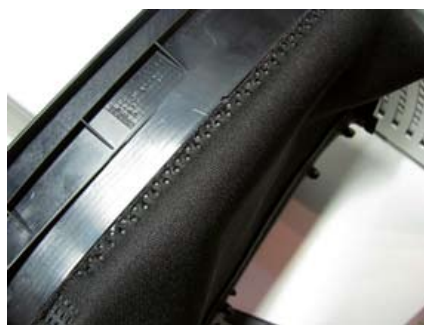
Detail ultrazvukového zvaru plast – koženka pre automobilový priemysel
