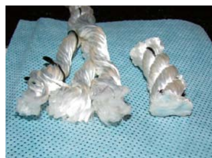
Delenie pletených lát (vpravo – ultrazukový rez bez rozpletania)
