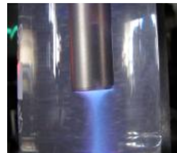
....čelo sonotródy vyžarujúce energiu ... ( foto archív firmy BELSON...)
