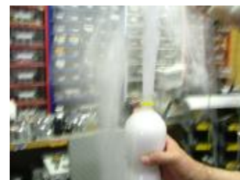
... demonštrácia odplynenia .... ( 350 ms impulz ultrazvuku ...)
