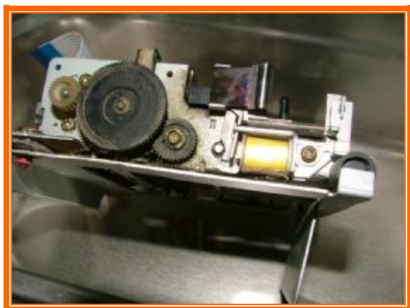
Blok pred ultrazvukovým čistením .
