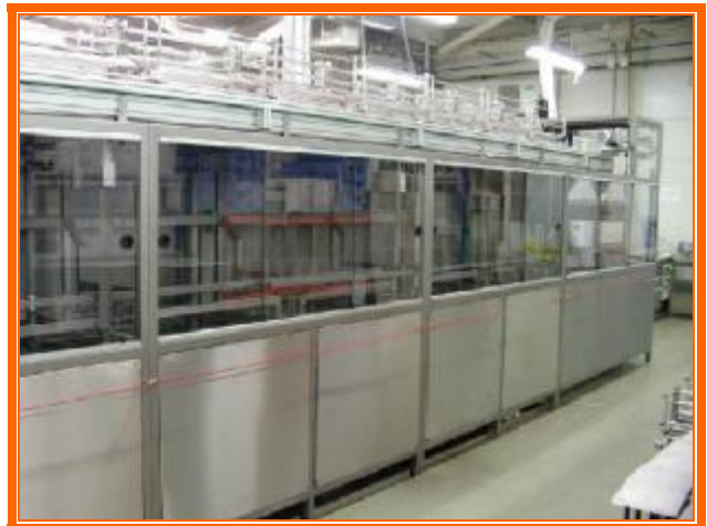
Moderná čistiaca linka –osadená ultrazvukom firmy BELSON. (40kHz a 135 kHz)
