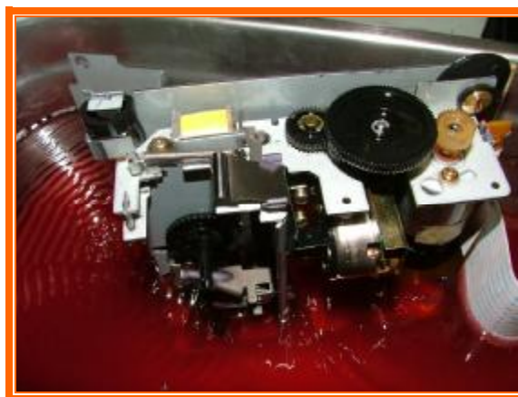
Blok po ultrazvukovom čistení (expoziícia cca 3 minúty/predmáčanie cca 3minúty/ULTRAZVUK vaňa UCE 03 – 40 kHz...)
