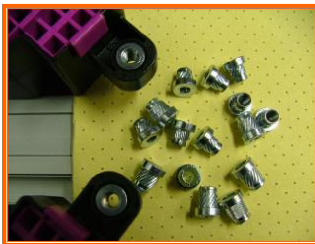
Detail maticového spoja vytvoreného s ultrazvukom .
